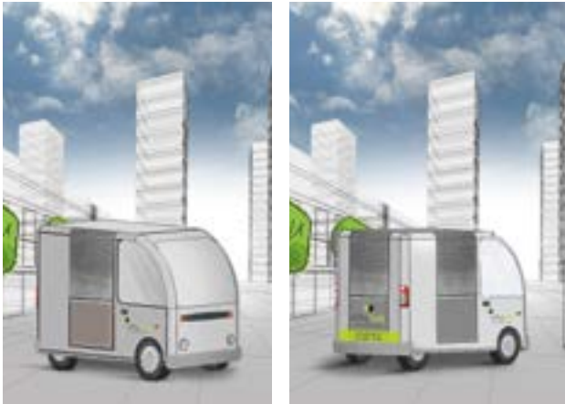
Afbeelding 4.4: Conceptontwerp voor City Hub met ruimte voor 3 tot 4 rolcontainers.
