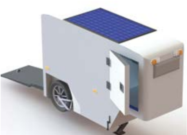
Afbeelding 4.10: Model van de verbeterde koel-vriestrailer.
