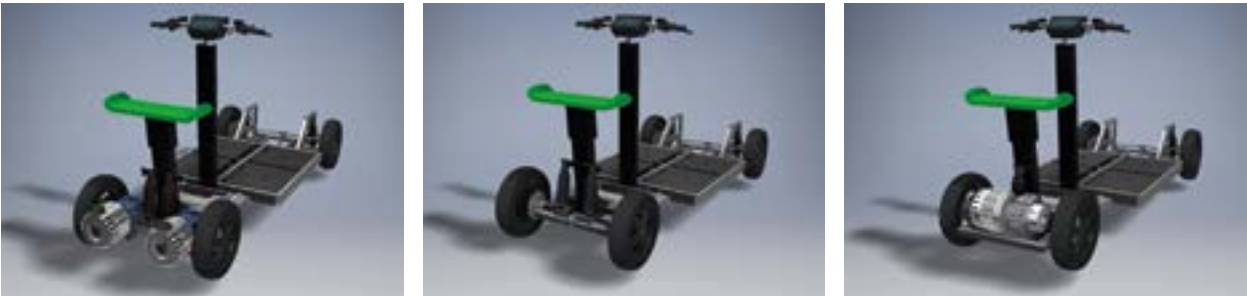
Afbeelding 4.8: Packaging van de aandrijving met achtereenvolgens transaxles, in-wheel-motoren en dual drive.
