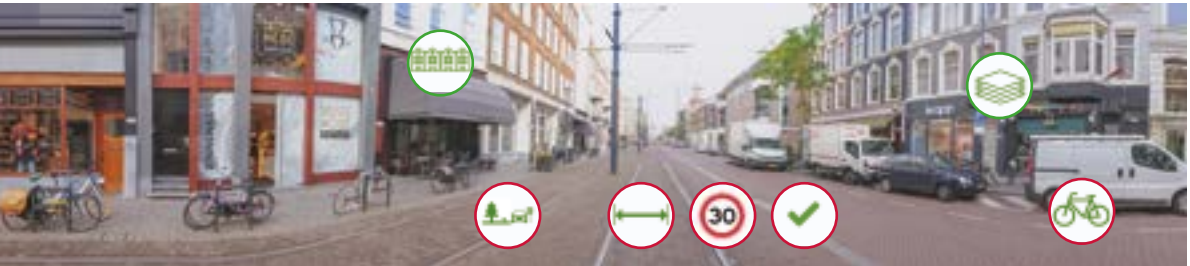
De Van Oldenbarneveltstraat heeft een moderne inrichting, maar er zijn nog diverse verbeteringen aan te brengen. Het snelheidsregime van 50 km/u past bijvoorbeeld niet bij de functie als winkelstraat. Verder zijn er weliswaar laad- en losplaatsen, maar nog steeds te weinig, waardoor er alsnog op de fietsstrook wordt geladen en gelost.
