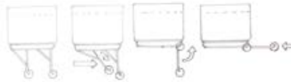
Afbeelding 4.7: Schets van de werking van het brancardsysteem.
